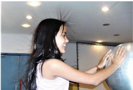
Como ilustrado pela foto, o gerador de Van de Graaf, equipamento popular em parques de ciência, permite o acúmulo de cargas elétricas em uma cúpula metálica. A distribuição de cargas na cúpula de um desses geradores, quando ninguém a toca, pode ser considerada esférica. Dois desses geradores, A e B, estão separados por uma certa distância. O gerador A contém uma carga  $+Q$ , e o gerador B, uma carga  $+2Q$ , com  $Q > 0$ .
