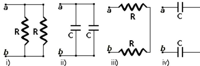
Assinale a alternativa que apresenta a sequência correta (i, ii, iii, iv), conforme o tipo de circuito, da resistência equivalente e da capacidade equivalente entre os pontos a e b.
